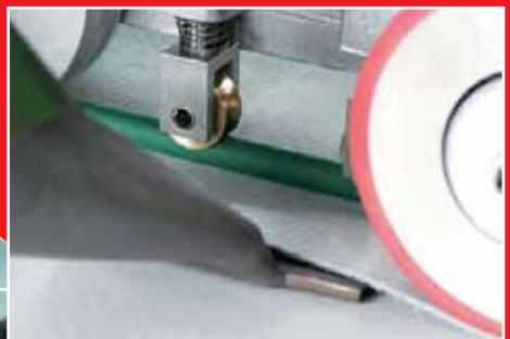
焊缝部位控制： 绿色传送带可控制热风只加热焊接缝部位
